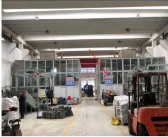
密闭生产装置：防止酸性气无组织排放
